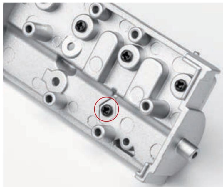
**Шаг 5.** Соедините стартер с крышкой стартера со стороны привода. Для этого совместите центровочные элементы деталей, исключая ошибки монтажа, и зафиксируйте детали винтом 2,0×4 (EP).
