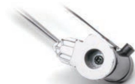
**Шаг 6.** Установите собранный стартер на блок двигателя (под крышкой коробки толкателей) и закрепите его с внутренней стороны блока винтом 2,0×4 (EP).
