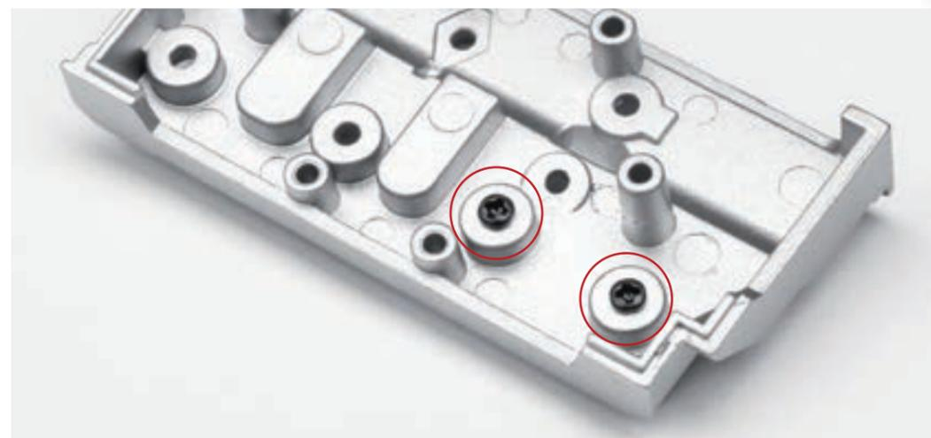
**Шаг 2.** Аналогичным образом в передней верхней части блока установите и закрепите двумя винтами 2,0x4 (EP) корпус маслоотражателя. При правильном монтаже детали крепежный штырь для трубки вентиляции картера находится в верхней части корпуса.
