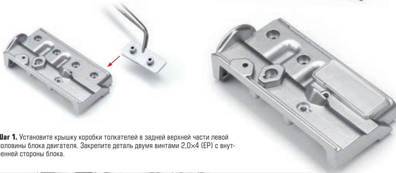
**Шаг 1.** Установите крышку коробки толкателей в задней верхней части левой половины блока двигателя. Закрепите деталь двумя винтами 2,0x4 (EP) с внутренней стороны блока.
